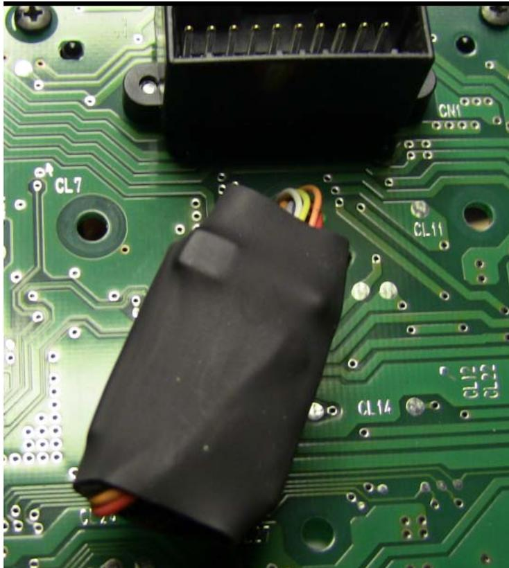
Das Loch ist jetzt mit Drähten voll, aber es hatte ja vorher auch einen Zweck: Durch dieses Loch (eines der wenigen Löcher ohne Schraube) führt(e) ein Verbindungszapfen zwischen den beiden Gehäuse-Hälften der Instrumententafel. Für diesen Zapfen ist kein Platz mehr, an der Vorderschale wird er abgeschnitten und an der Unterschale wird die Zapfenaufnahme angeschrägt, damit die Kabel dran vorbei passen:
